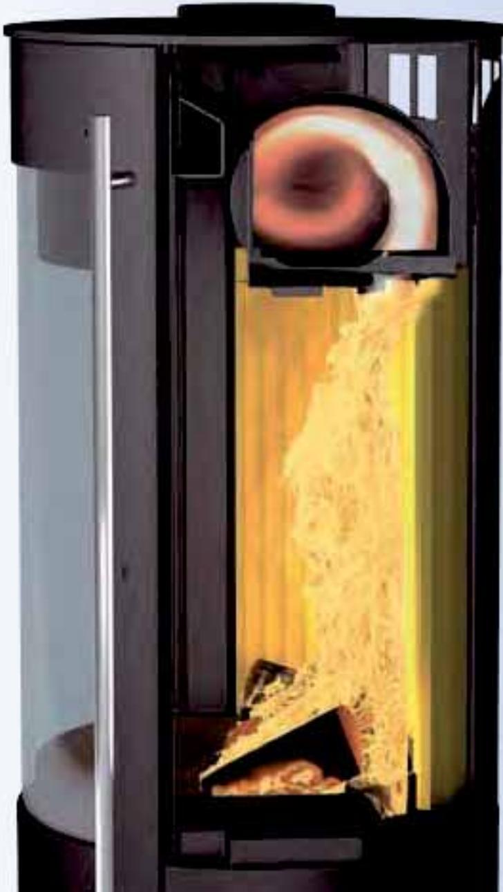
In der Wirbelbrennkammer erfolgt eine optimale Vermischung der Verbrennungsluft mit den Heizgasen. Die Verweildauer der Heizgase in der Brennzona wird verlängert. Hierdurch wird eine optimierte Nachverbrennung ermöglicht, die zu einer weiteren Verringerung der Emissionen und Feinstaubpartikeln führt.
