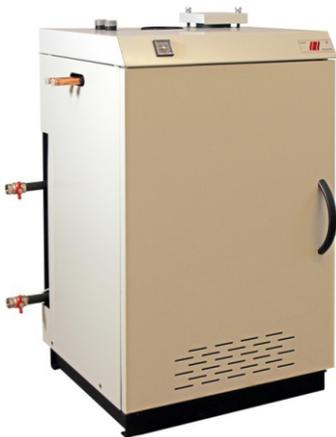
Der Forster Etagenheizkessel Typ: ETH 14 geschlossene Anlage ist ein Spezialkessel für die Verbrennung des **Regelbrennstoffes Braunkohlebrikett**. Durch den Einbau einer Schamottbrennkammer findet die Verbrennung im unteren Abbrand statt.
