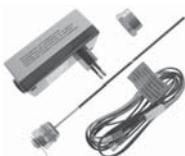
**Fremdstromanode Correx** wartungsfrei zum Einbau in den Wassererwärmer anstelle der Magnesiumanode, bestehend aus Potentiostat mit Befestigungsrahmen, Netzkabel, Titananode für Muffenmontage. Spannung 230 V
