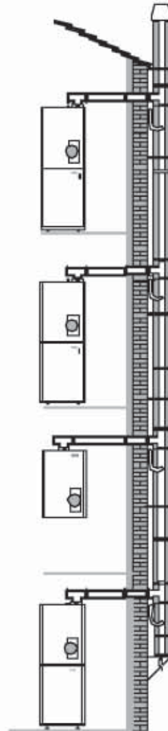
Montage an der Außenwand
