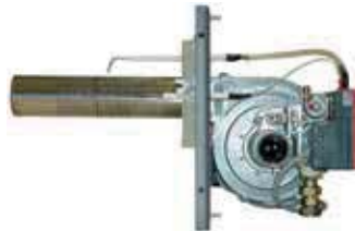
Venturi und Gasventil (Detail)
